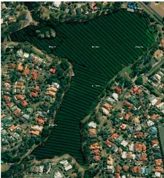
Figure 8: Bathymetric Survey
